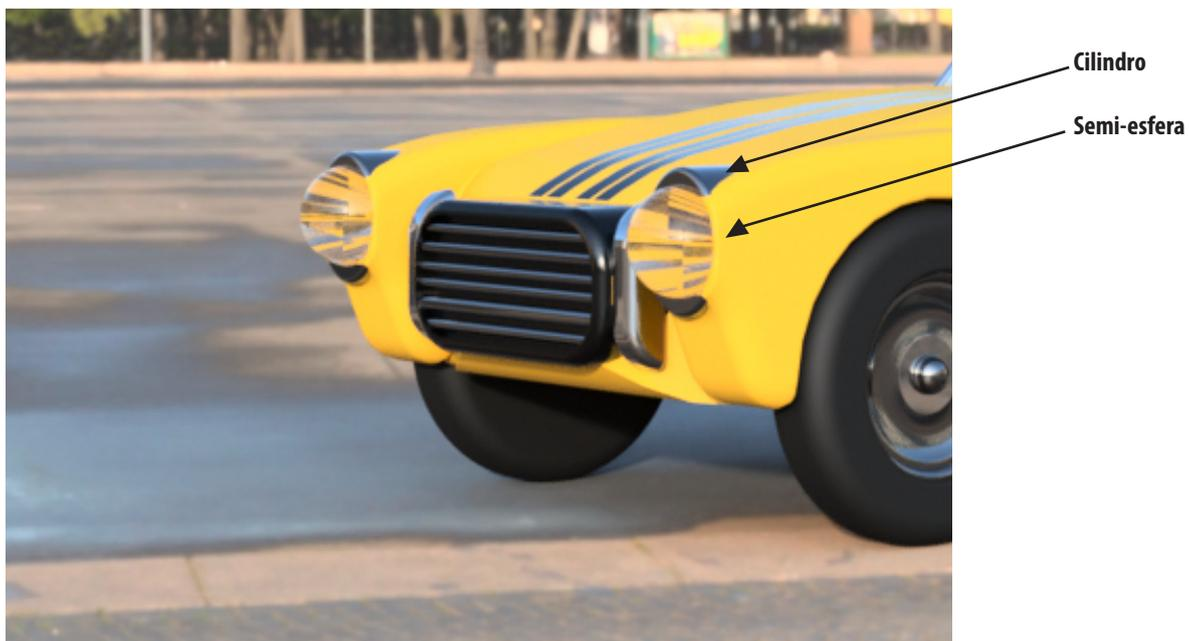
Na grelha do radiador criei um paralelepípedo, ao qual fiz "Fillet" nas arestas, de maneira a ficar bem arredondado. O passo seguinte foi criar paralelepípedos para a grelha que depois abaulei.
